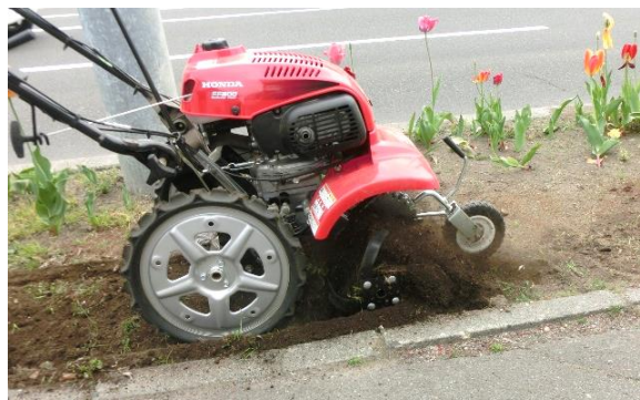
購入した耕うん機(ホンダ製) フロントロータリー式、1.5KW
